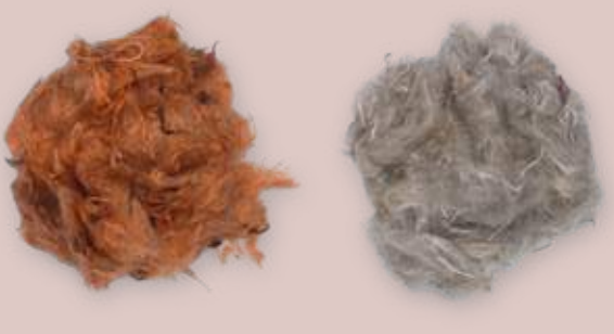
20% sustainable fiber from waste + 80% standard acrylic fiber. 20% de fibra sostenible a partir de los residuos + 80% de fibra acrílica estándar.
